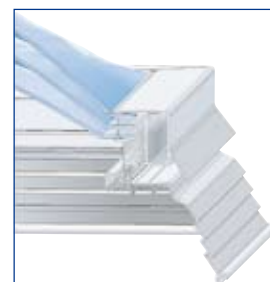
Sicherheitsrahmen (optional) Lichtkuppel classic 3-schalig im Querschnitt
